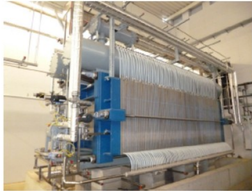
Abb. 2: Einer der drei 2 MW-Elektrolyseure
